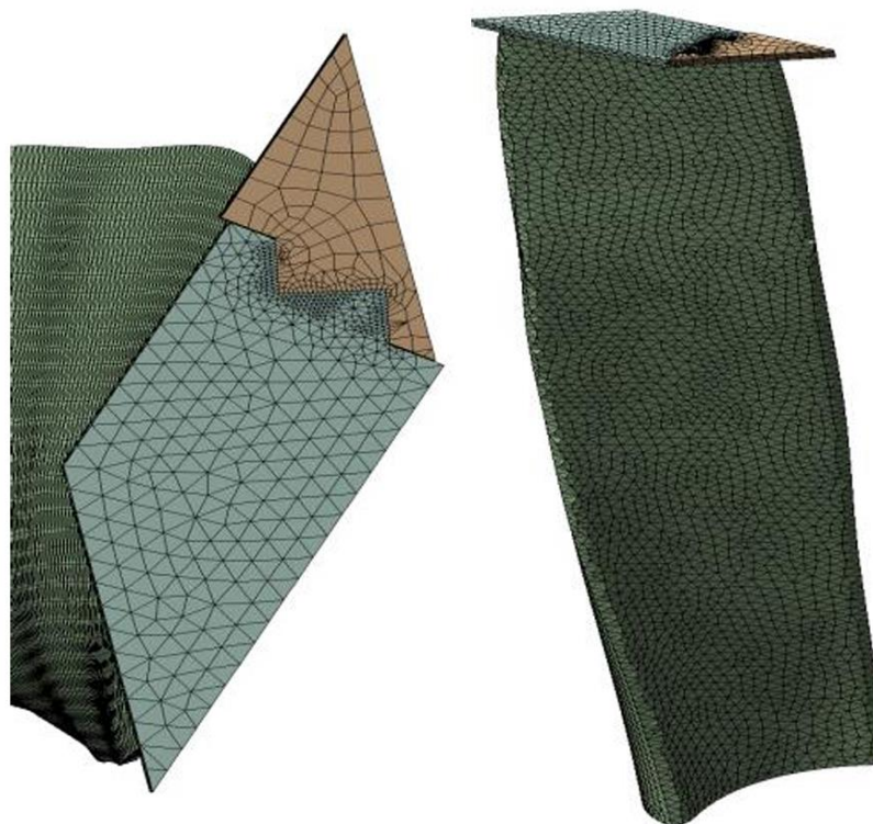
Рисунок 4.13 – Скінченно-елементна сітка лопатки
